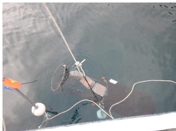
翌年の 2020 年にも実証実験の場所を変えて実施した結果、それまで使用してきたアナゴ籠より小型個体から大型個体まで捕獲でき、従来のアナゴ籠では一週間ほどの設置で脱出を因るため編地の切断損傷が見受けられたが、連続捕獲装置は損傷が無く一週間以上の設置、回収で頻度が少なくなり捕獲効率が向上
